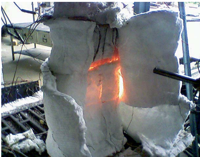
Slika 7. Izgled ispitnoga probnog uzorka neposredno nakon provjere elektrotopnim načinom standardnog ispitivanja vatrootpornosti uzoraka čeličnih stupova. Stupovi su obloženi protupožarnim betonom po sustavu Vatrut. Ispitivanje je obavljeno u ispitnoj peći laboratorija LTM Lučko.
