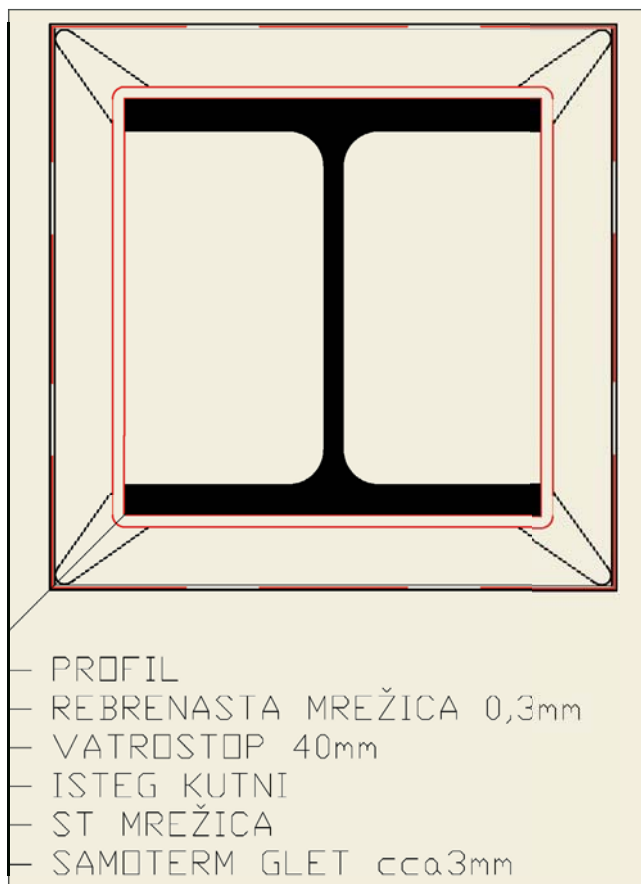
Slika 1. Detalj zaštitne protupožarne obloge stupa.
